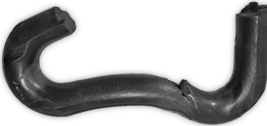
Rys. 3. Eksploatacyjne pęknięcie ogniwa w zgrzeinie oraz wtórne pęknięcie ogniwa w łuku przy dużej deformacji plastycznej [opracowanie własne]
