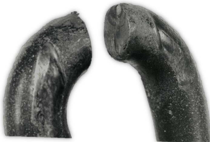
Rys. 4. Eksploatacyjne pęknięcie zmęczeniowe w osi ogniwa - widoczne ognisko pęknięcia na zewnętrznym profilu łuku ogniwa i zużycie od współpracy ogniwa poziomego z zębami bębnow napędowych [opracowanie własne]
