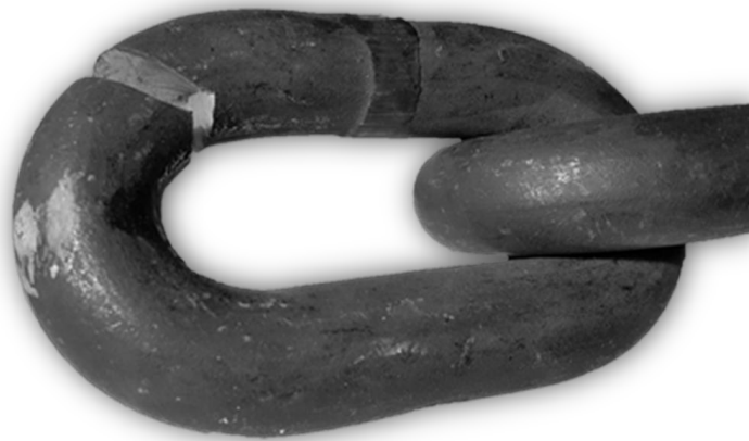
Rys. 2. Typowe pęknięcie zmęczeniowe ogniwa łańcucha ze strefą przelomu zmieniającego kierunek [opracowanie własne]
