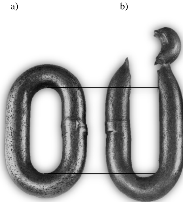
Rys. 1. Przykład typowego zniszczenia ogniwa po statycznym zrywaniu: a) widok ogniwa przed zerwaniem, b) ogniwo zerwane [opracowanie własne]
